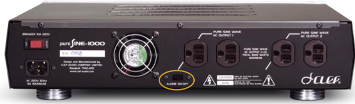
สวิตช์ปรับโยกเพื่อ 'เปิด/ปิด' สัญญาณ Alarm (วงกลม) ที่มีไว้เตือนเวลาที่กระแสไฟจากภายนอกเข้ามา 'ต่ำ' หรือ 'สูง' เกินกว่าระดับที่เครื่องจะรับมือได้
